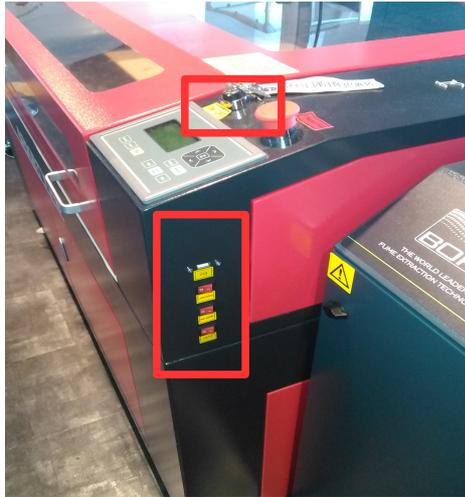
1) **Vous devez allumer la machine de découpe**, sinon vous aurez un message d'erreur. En effet, si la machine est éteinte aucune transmission n'est possible. Pour allumer la machine il faut juste tourner la clé présente dessus vers la droite et d'allumer les trois boutons que vous trouverez sur le côté de la machine.
