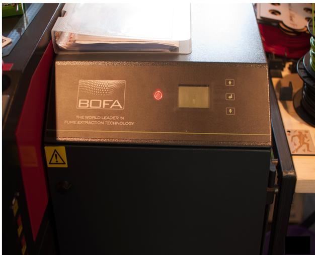
Si vous êtes prêt à lancer la découpe, une dernière étape reste à faire. A droite de la machine de découpe se trouve un appareil qu'il faut absolument mettre en marche avant tout lancement d'une découpe.
